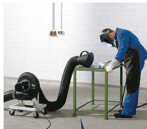
Exemple d'application : Ventilateur mobile
