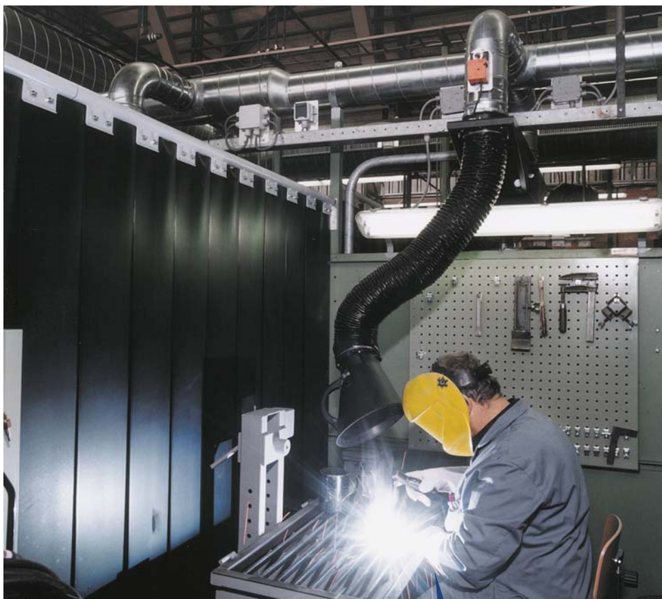
Przykład zastosowania: Teleskopowe ramię odciągowe w kabinie spawalniczej
