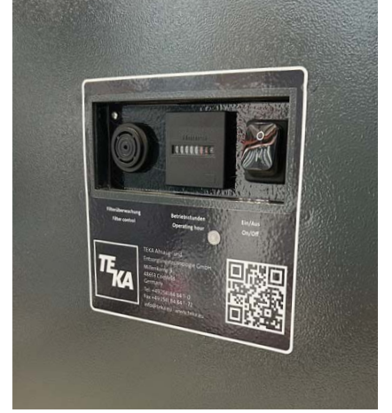
Çalışma saati sayacı ve sinyal kornası ile genel bakışlı kumanda
