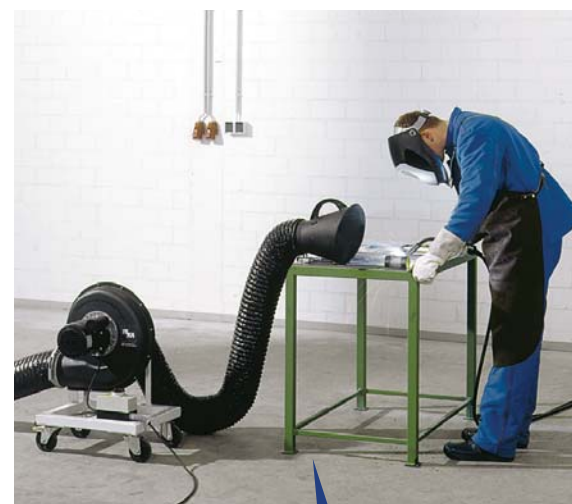
Exemple d'application : Ventilateur mobile
