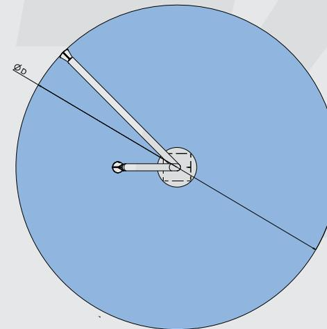
Abb. Absaugarm mit Erfassungsradius in Draufsicht
