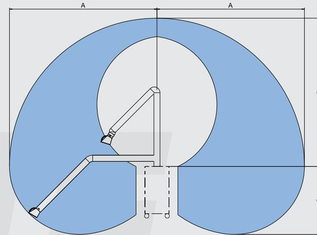
Abb. Absaugarm mit Erfassungsradius in Seitenansicht
