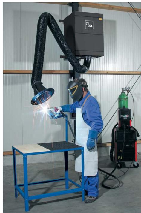
Ejemplo de aplicación: CareMaster montado en la pared con placa-tobera adicional en la campana de aspiración
