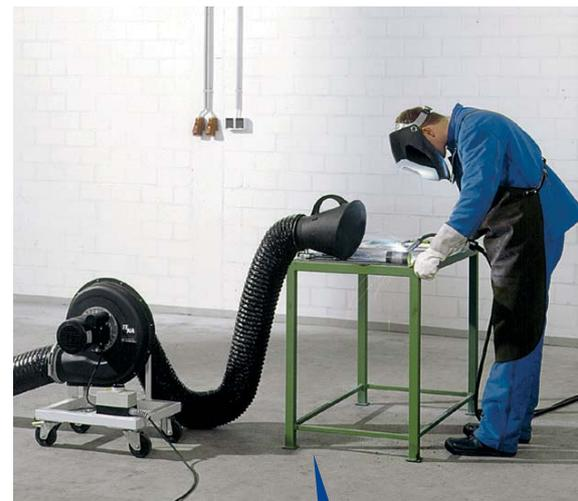
Ejemplo de aplicación: Soplador de aspiración móvil
