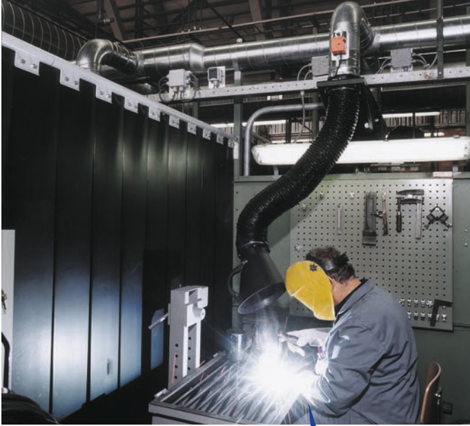
Uygulama örneği: Kaynak kabininde teleskopik emme kolu
