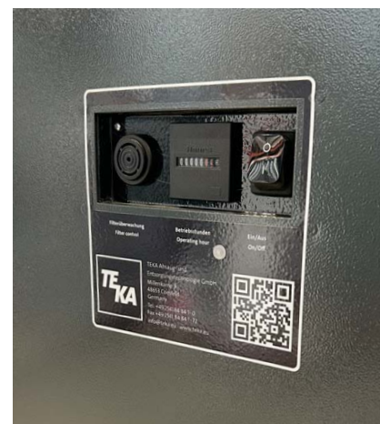
Sterowanie z licznikiem godzin pracy i buczkiem sygnałowym
