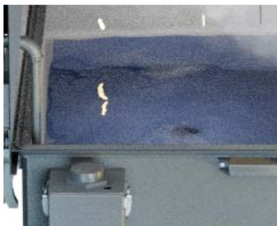
Iskry wpadają do kąpeli wodnej i wygasają
