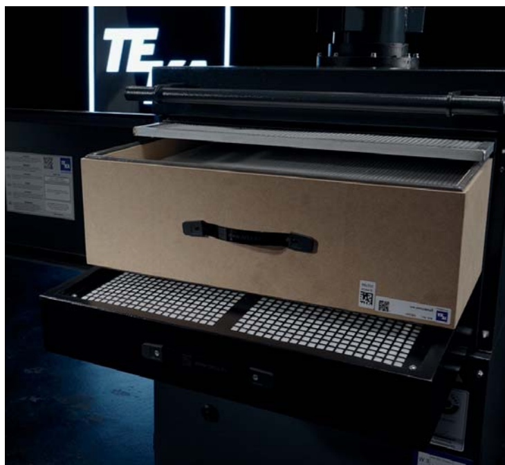
Afbeelding toont speciale uitvoering met actieve koolfilter
