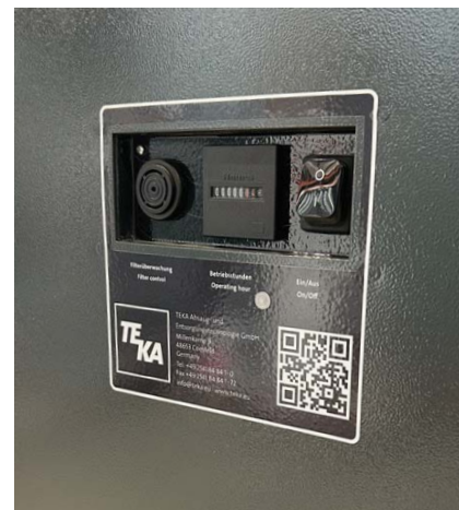
Übersichtliche Steuerung mit Betriebsstundenzähler und Signalhupe
