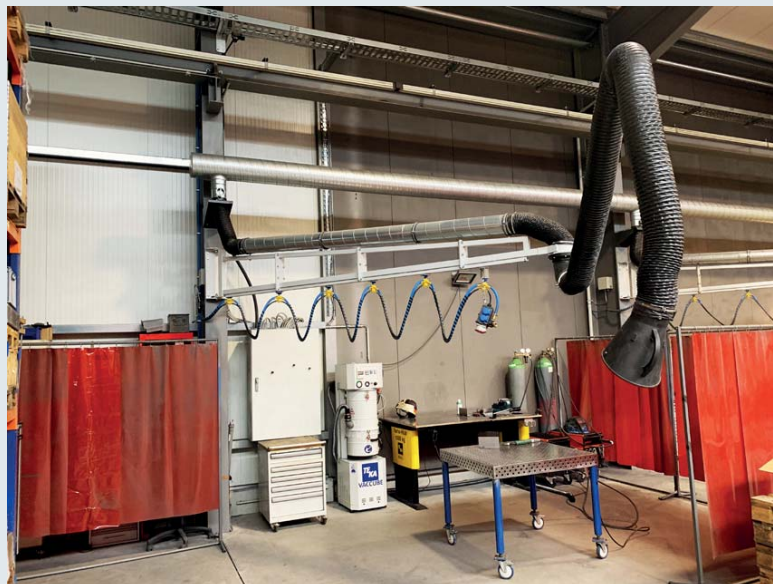
Brazo de aspiración con soporte de pared y carril-guía
