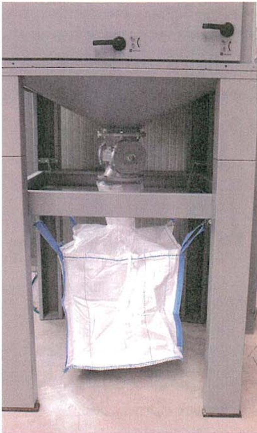
Die Zellenradschleuse befördert die Partikel kontinuierlich in das Big-Bag.
