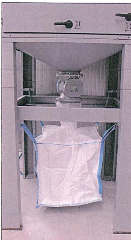
Die Zellenradschleuse befördert die Partikel kontinuierlich in das Big-Bag.
