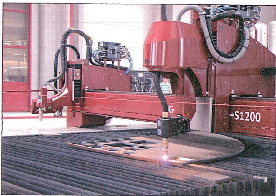
Die Plasmaschneidanlage weist eine sehr hohe Schnitt- und Lochqualität auf.
