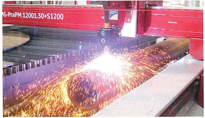
Le traitement 3D des tuyaux et des profilés fait partie du très large éventail de tâches du système de coupe multifonctionnel.
