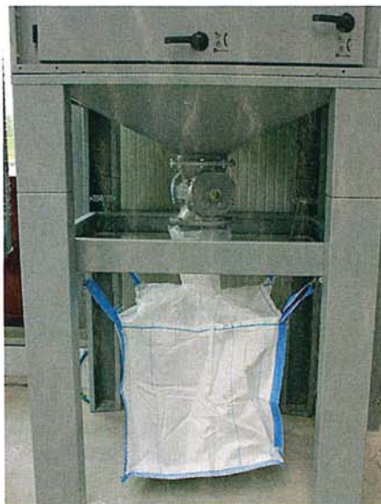
La fermeture rotative transporte continuellement les particules dans le big-bag.
