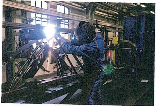
Die Brennerabsaugung schützt Schweißer direkt am Arbeitsplatz. (Bilder: Teksa)
