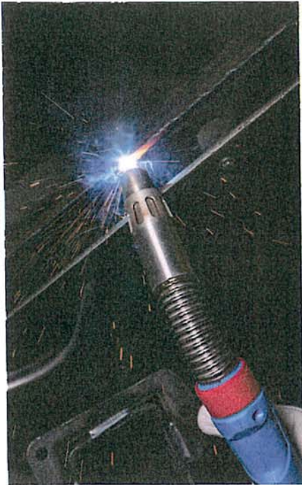
Der Absaugbrenner nimmt den Rauch punktgenau an der Entstehungsstelle auf.
