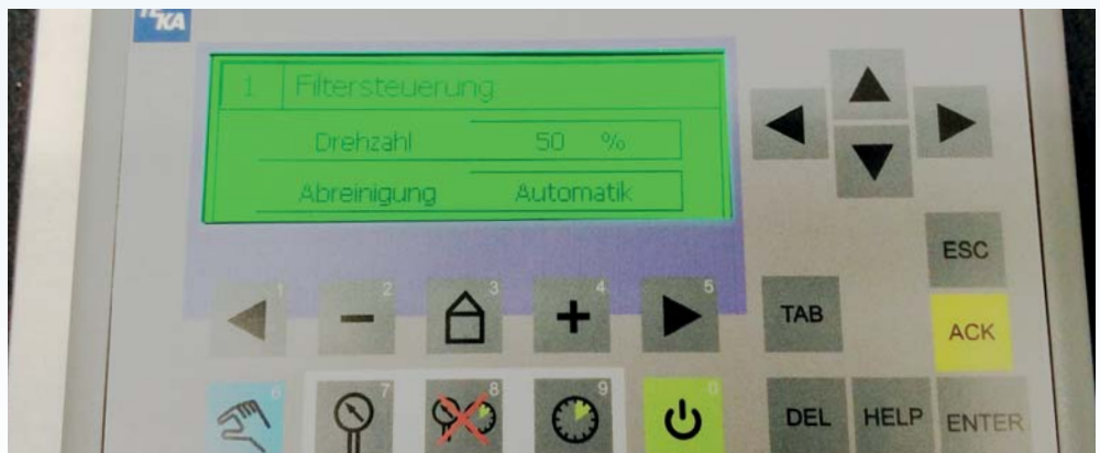
Встроенное управление Siemens S7
