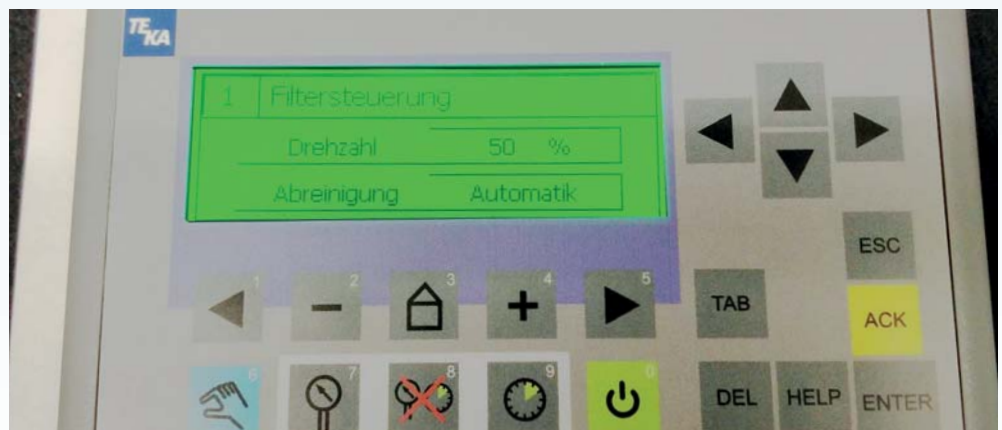
zintegrowane sterowanie Siemens S7
