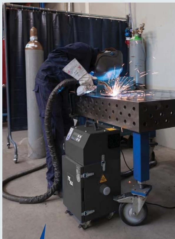
Пример использования: вытяжка интегрированная в горелке
