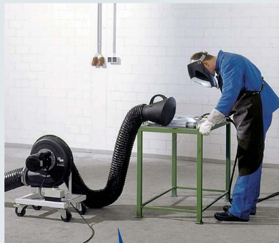
Пример использования: мобильный вытяжной вентилятор
