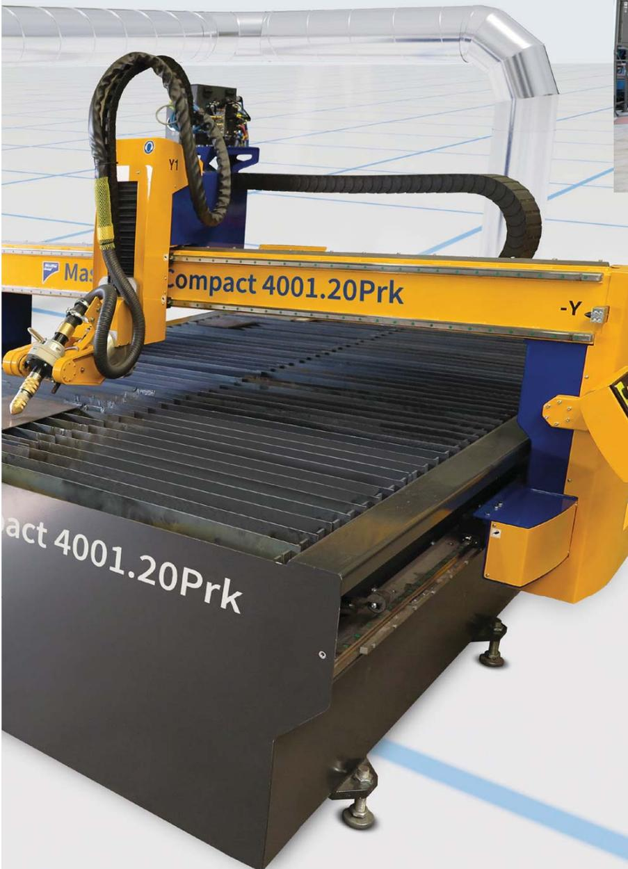
*ТЕКА столы для резки металла построены в модульном исполнении доступны в стандартных размерах от 2 до 12 м<sup>2</sup>.*
