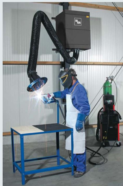
Пример использования: Care-Master настенный монтаж с дополнительной платой на вытяжном колпаке
