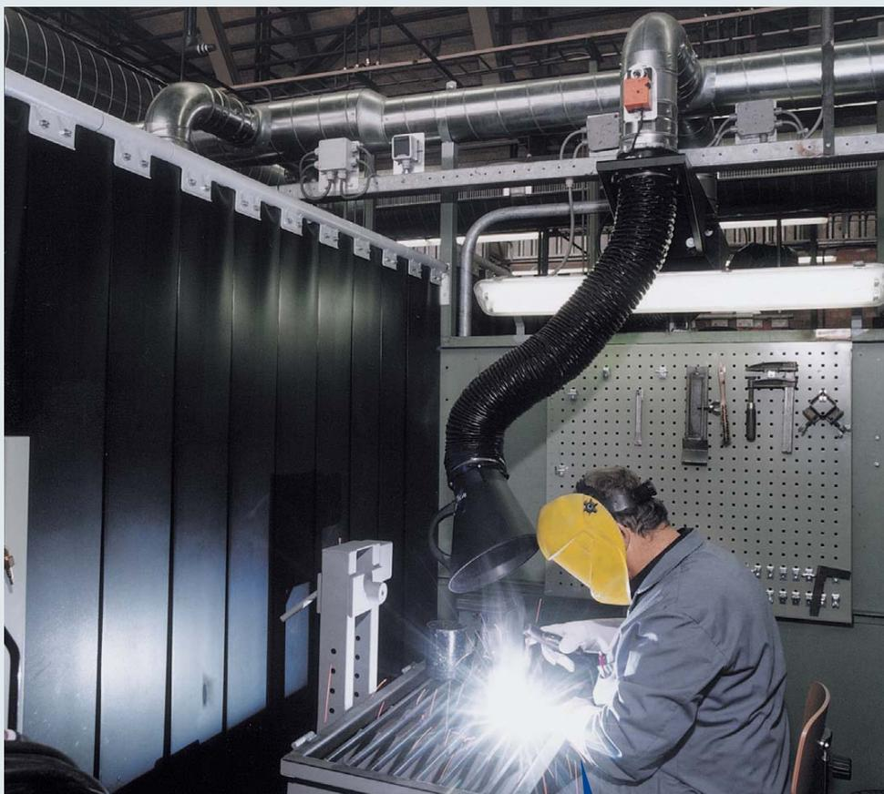
Пример использования: телескопический вытяжной рукав в сварочной кабине
