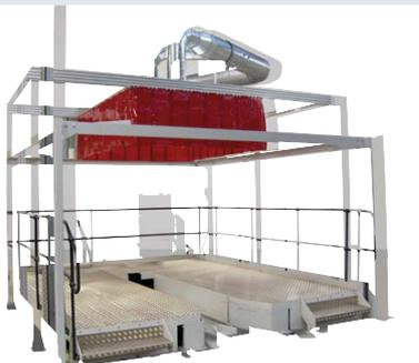
*Специальный вытяжной навес с ламелями над сварочными роботами*
