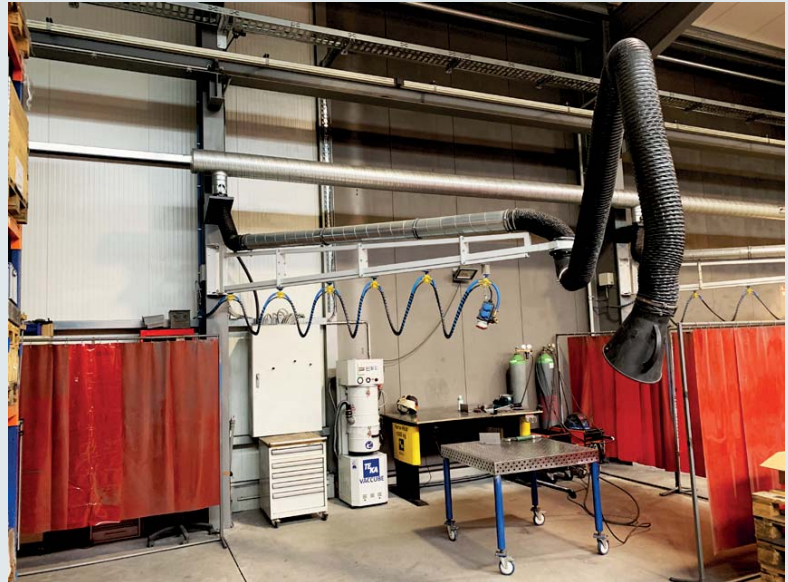
Absaugarm mit Wandausleger und Führungsschiene
